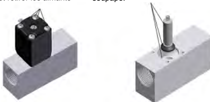
Illustration 9 : nettoyage d'une électrovanne
